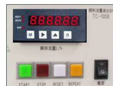
燃料流量表示計 TC-200B シリーズ 外形寸法 : W160×H100×D160
