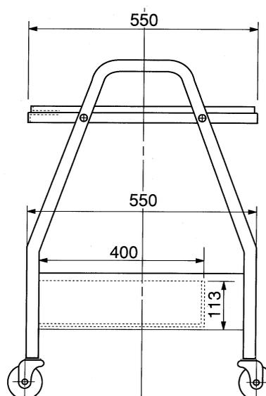
外形寸法図 (単位: mm)
